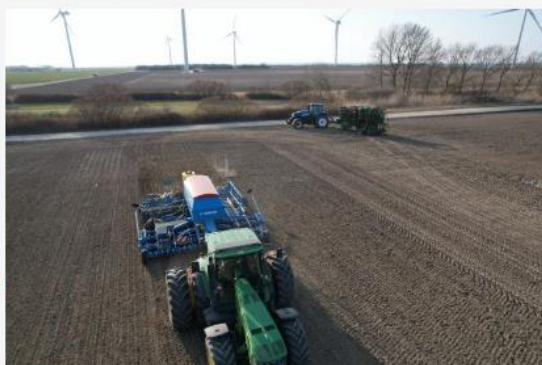
I landsforsøget på Vestlolland bliver det undersøgt, hvor præcist tre såmaskiner med frøsåkasse sørger for græsfrøene ud. Foto: Kristian Juranich.
