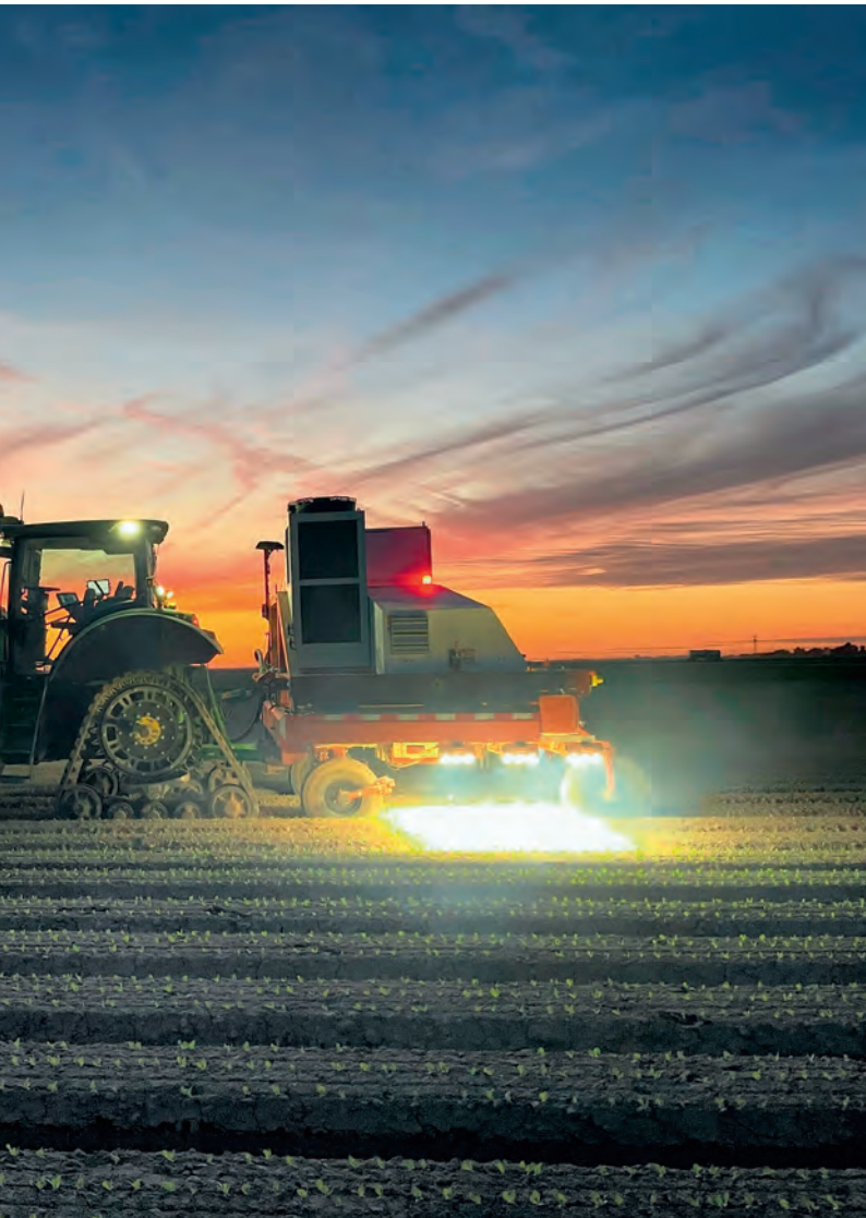
Laser Weeder har en arbejdsbredde på cirka 6 meter.
