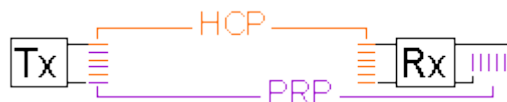
Figur 1. Skitse af sender- (TX) og modtagerspøler (RX) i et DUALEM-421S system. For HCP er spølen i samme horisontale plan som senderspølen. For PRP er spølen vinkelret og centreret omkring senderspølen's horisontale plan.
