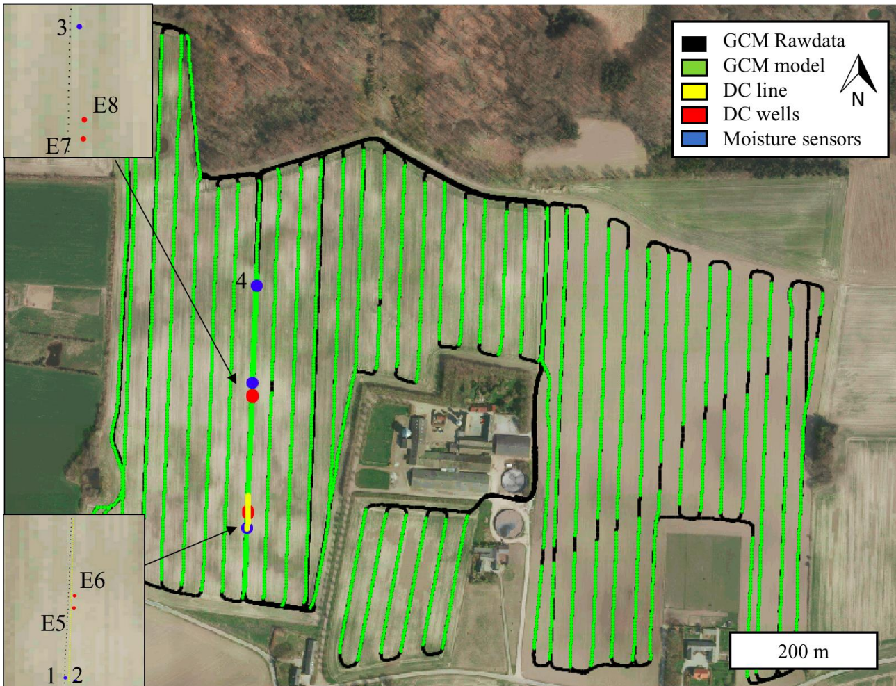
Figur 8. Oversigtskort fra Fensholt med GCM målinger. GCM målinger er vist med grønne punkter. Gule punkter markerer borer i området. Røde punkter markerer DC målinger i jorden på kalibreringslinjen, og blå punkter er fugtigheds sensorer som måler jordens fugtighed.
