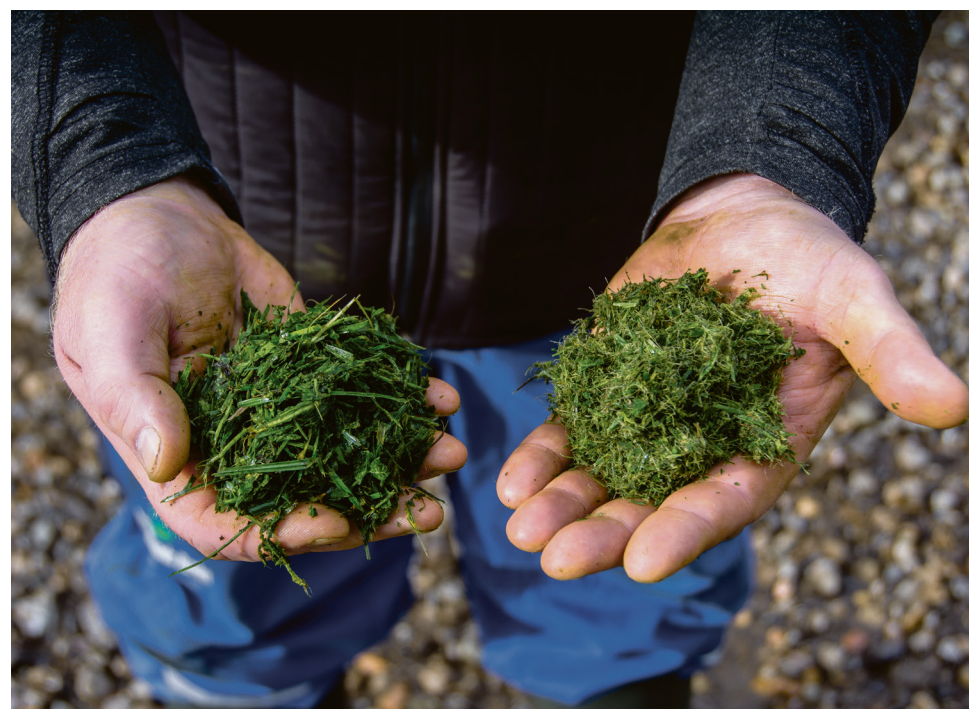
4. Efter at være kørt gennem skruepresserne skilles det pressede græspulp fra og bruges i gårdens biogasanlæg. Saften, der indeholder proteinet, pumpes videre og samles i en stor buffertank. Til venstre ses det friskslåede græs – til højre ses græspulpen, der skilles fra saften.
