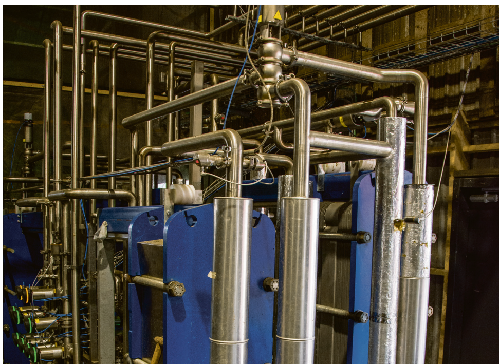
5. Efter at pulpen er skilt fra, sendes saften med proteinet gennem en varmeveksler og opvarmes til 78-80 grader for at udfælde proteindelen.
