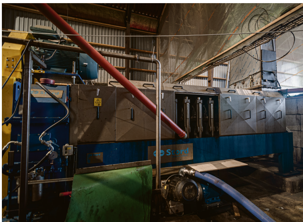
3. Herefter køres massen gennem en stor skruepresser, som presser saften ud af græsmassen.
