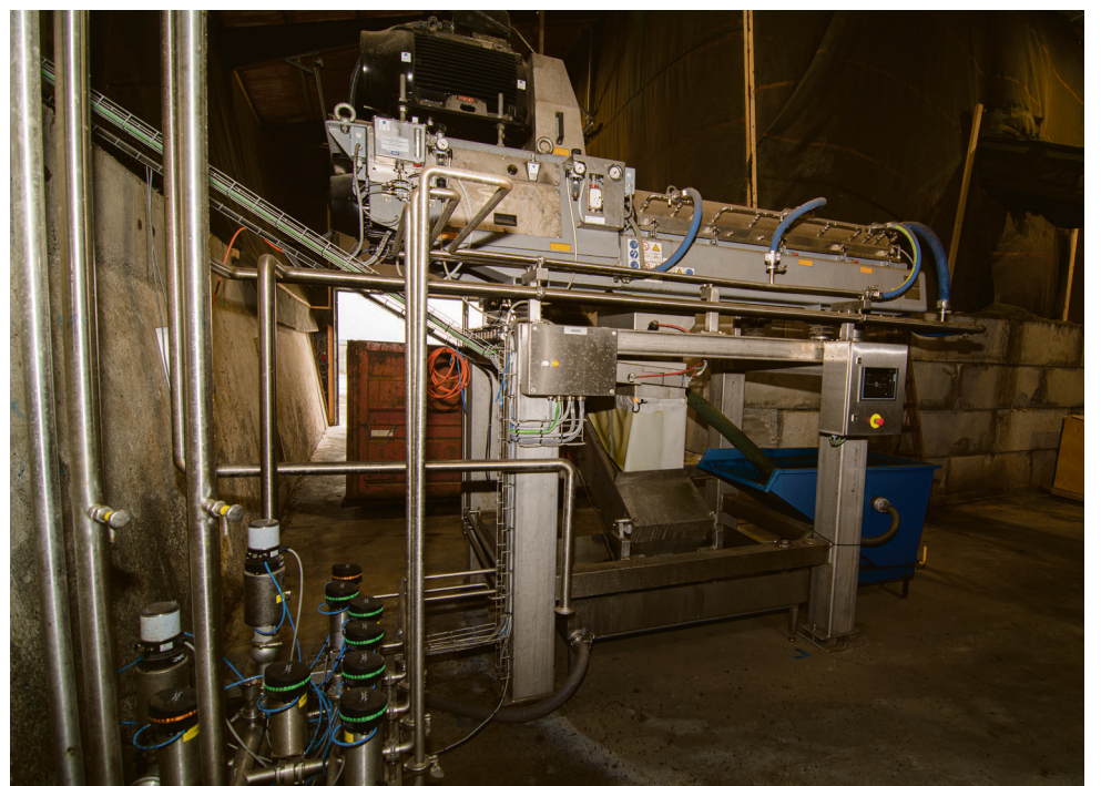
6. Efter opvarmningen føres det videre ind i en dekanter, der slynger saften, så proteinet skilles fra som granulat med et tørstofindhold på ca. 50-55 pct.
