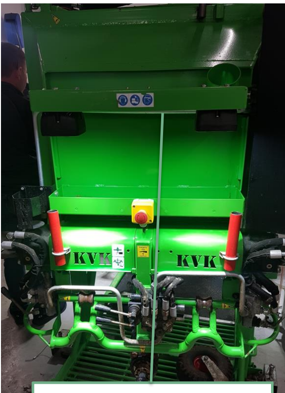
Kameraerne monteres bag på eksisterende lys i et beslag, som beskytter kameraerne.
