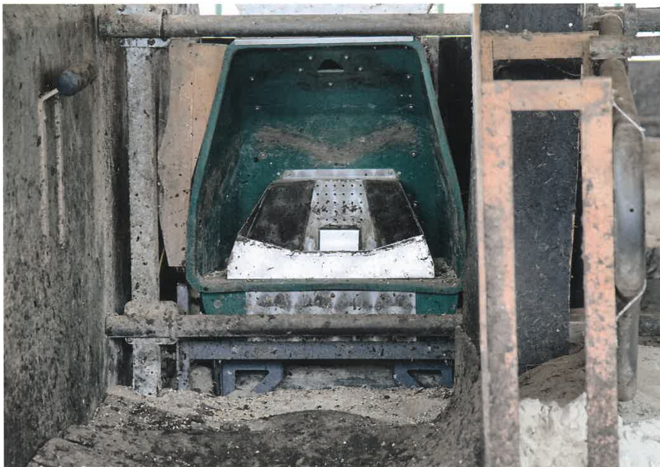
Metanmængden måles i GreenFeedere, som her er installeret i en sengebås. Foto: Peter W. Mogensen
