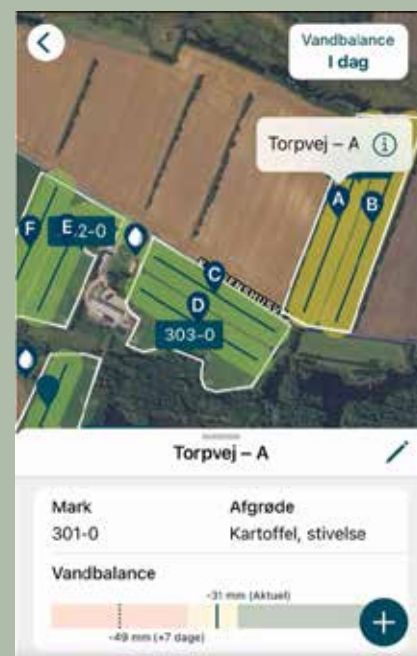
Figur 2: eksempel på vandingsmodulet i FarmTracking. I eksemplet ses det at mark 301-0 den pågældende dato er i gul zone med et vandunderskud på 31 mm, om 7 dage er vandingsunderskudet estimeret til -49 mm. Denne mark har aktuelt behov for vanding.
