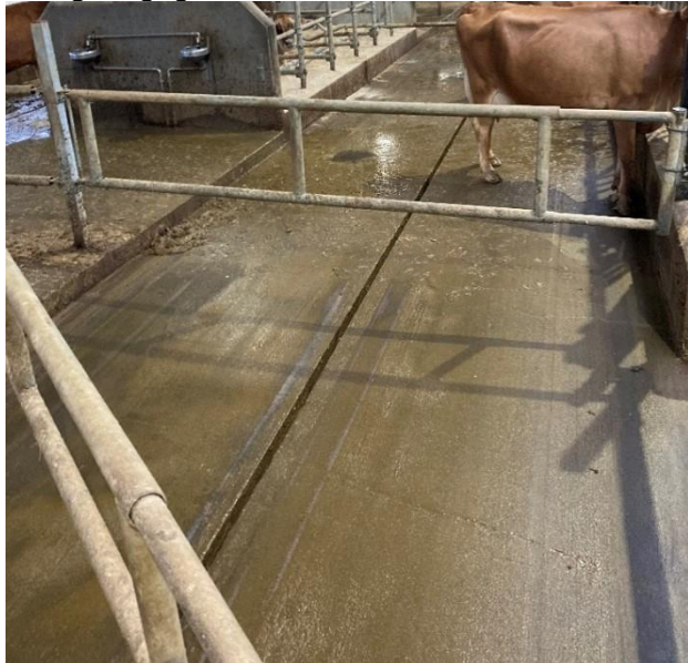
Figur 1. Skraber på gulvet og i langsgående kanal.
