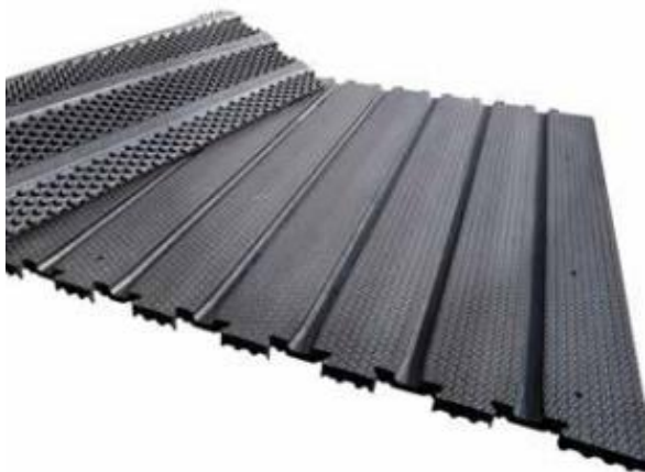
Figur 1. Gummibane med spalteriller til eftermontering på fast gulv eller spalter. Trædefladen er med 6 % fald til spalteriller.
