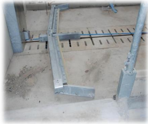
Figur 1. Vinkling af skraber for hurtig aflevering.
