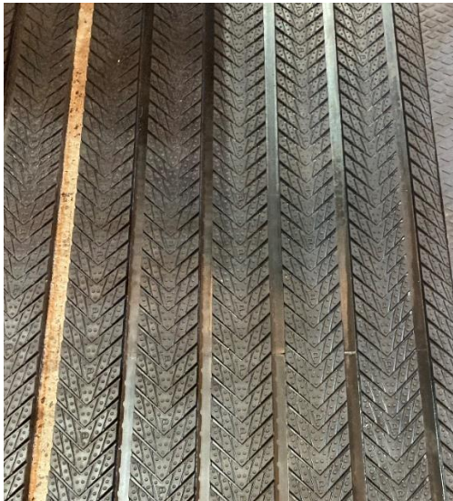
Figur 1. Gummibane med spalteriller til eftermontering på fast gulv eller spalter. Trædefladen er med fald til spalteriller.
