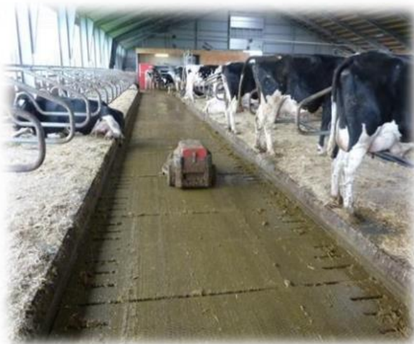
Figur 3. Rengøring med skraberobot.
