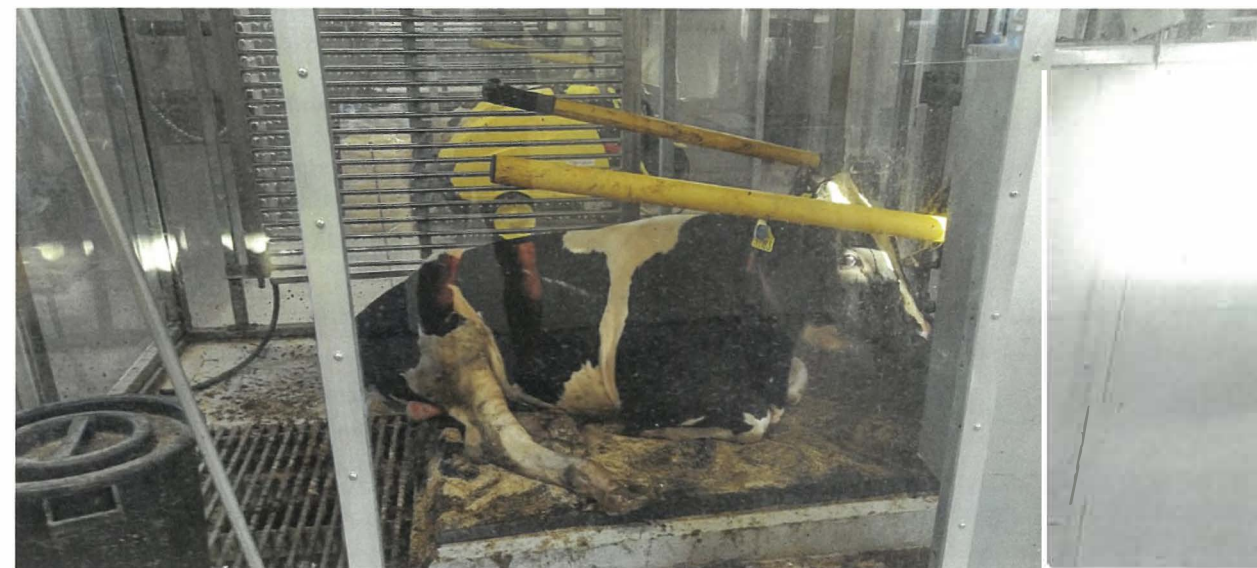
En slagtekalv på 8 måneder i et respirationskammer på Danmarks KvægforskningsCenter (DKC). Kammeret er en lukket plexiglasskabe, hvor luften suges ud kontinuerligt, og der måles bl.a. metan i denne luft. Kalven står opbundet, og man åbner kun for kassen via en sluse, når der fodres og rengøres/strøs, dvs 2 gange dagligt. Kalven er typisk i kassen i 3 døgn. Foto: Mogens Vestergaard
