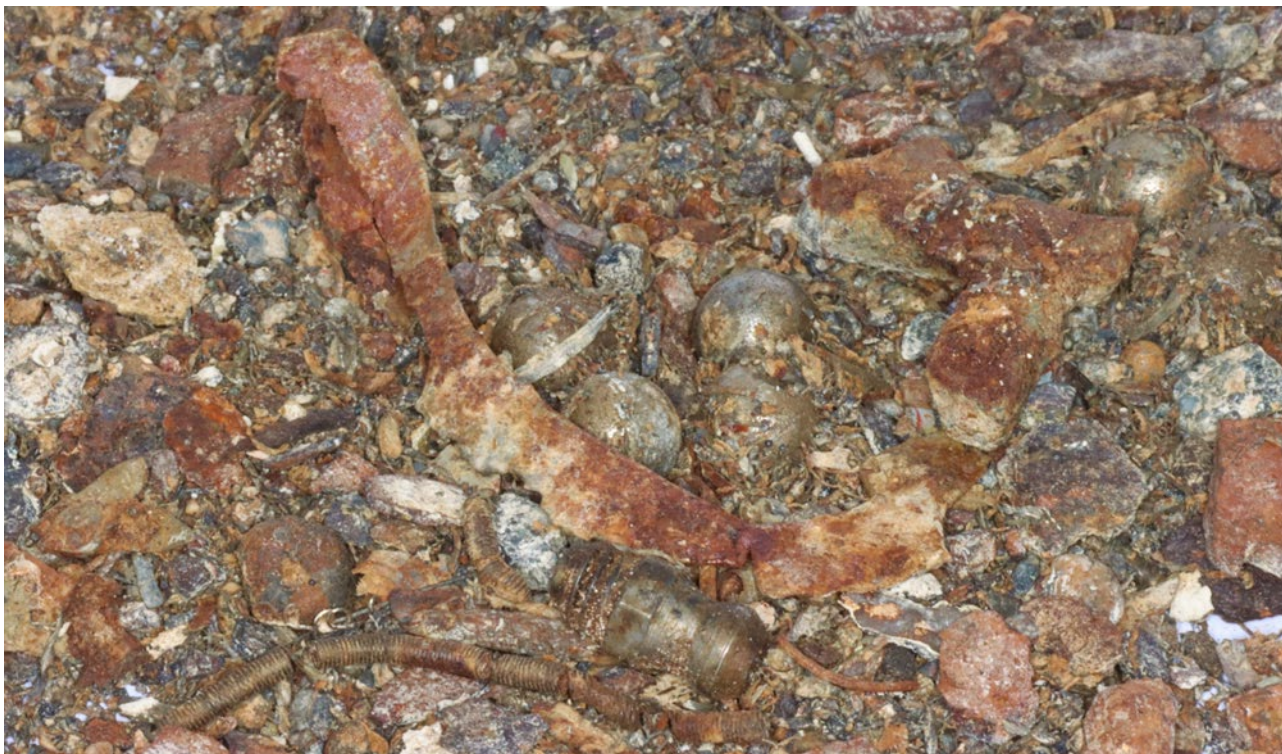
Foto 1. Ferromagnetiske emner tilbageholdt på magneter monteret på foderblanderen i besætning B (Tabel 1). Den største andel af materialet er ubestemmelige afslag og ruststykker. Der kan identificeres kugler fra kugleleje, ståltråd, tynd jernplade, et vinklet stykke jern og en fjeder.
