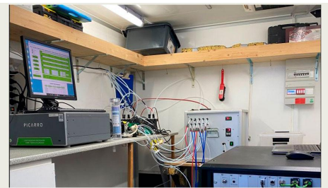
Målinger af emissioner fra en mekanisk ventileret stald med malkekøer. Data indsamles igennem ét år for at kunne medtage årstidsvariationen.
