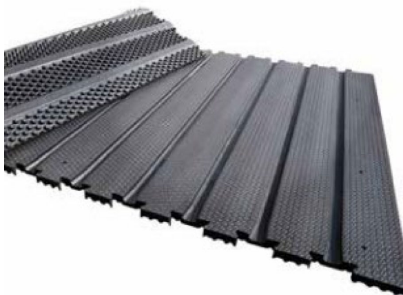
Figur 1. Gummibane med spalteriller til eftermontering på fast gulv eller spalter. Trædeflader er med 6 % fald til spalteriller.
