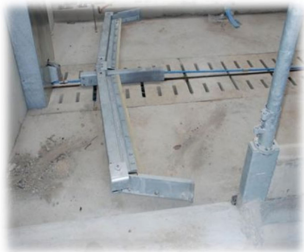
Figur 1. Vinkling af skraber for hurtig aflevering.
