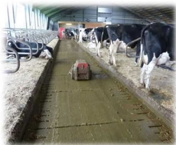
Figur 3. Rengøring med skraberobot.
