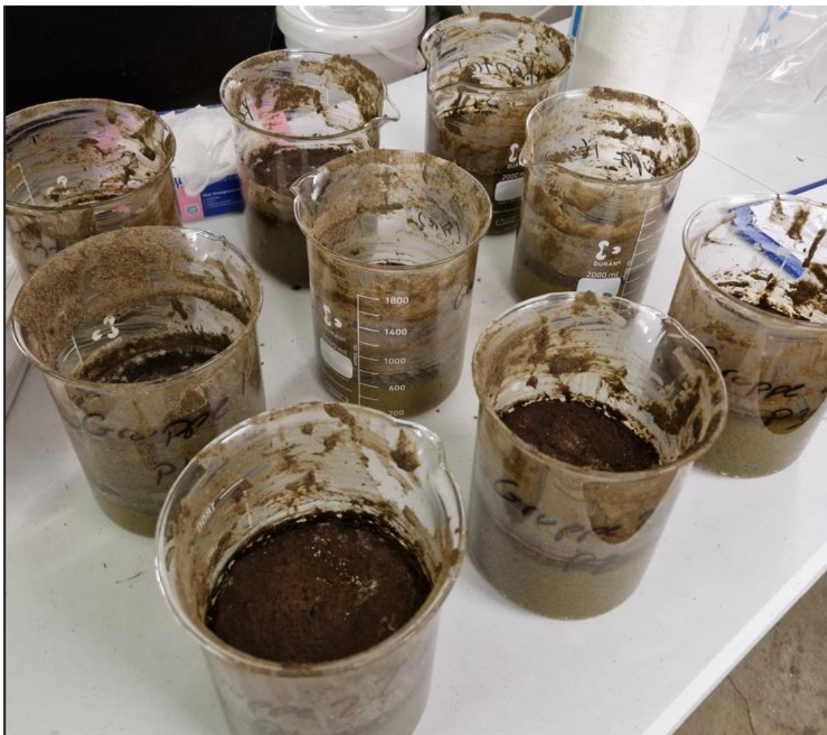
Figur 2. Billede af 2000 ml bægerglas med 1000 ml gylle i. Grupperet inden tredje afmåling af massefylden.
