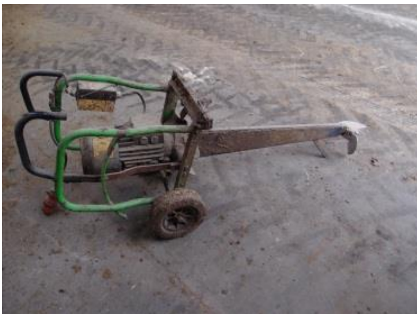
Figur 6. Håndholdt gylleomrører, som kan føres ned igennem spalterne og derved omrøre et mindre område i gyllekanalen.
