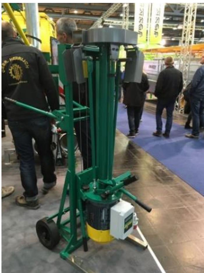
Figur 7. Kraftig model af håndholdt gylleomrører, som kræver et åbningshul på minimum 30 cm x 35 cm.
