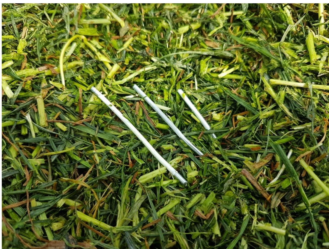
Foto 1. Testsæt med tre stykker hegstråd på henholdsvis 30, 45 og 60 mm. Trådstykkerne blev anvendt til test af metaldetektorer på finsnittere ved høst af 1.slæt kløvergræs på skår.
