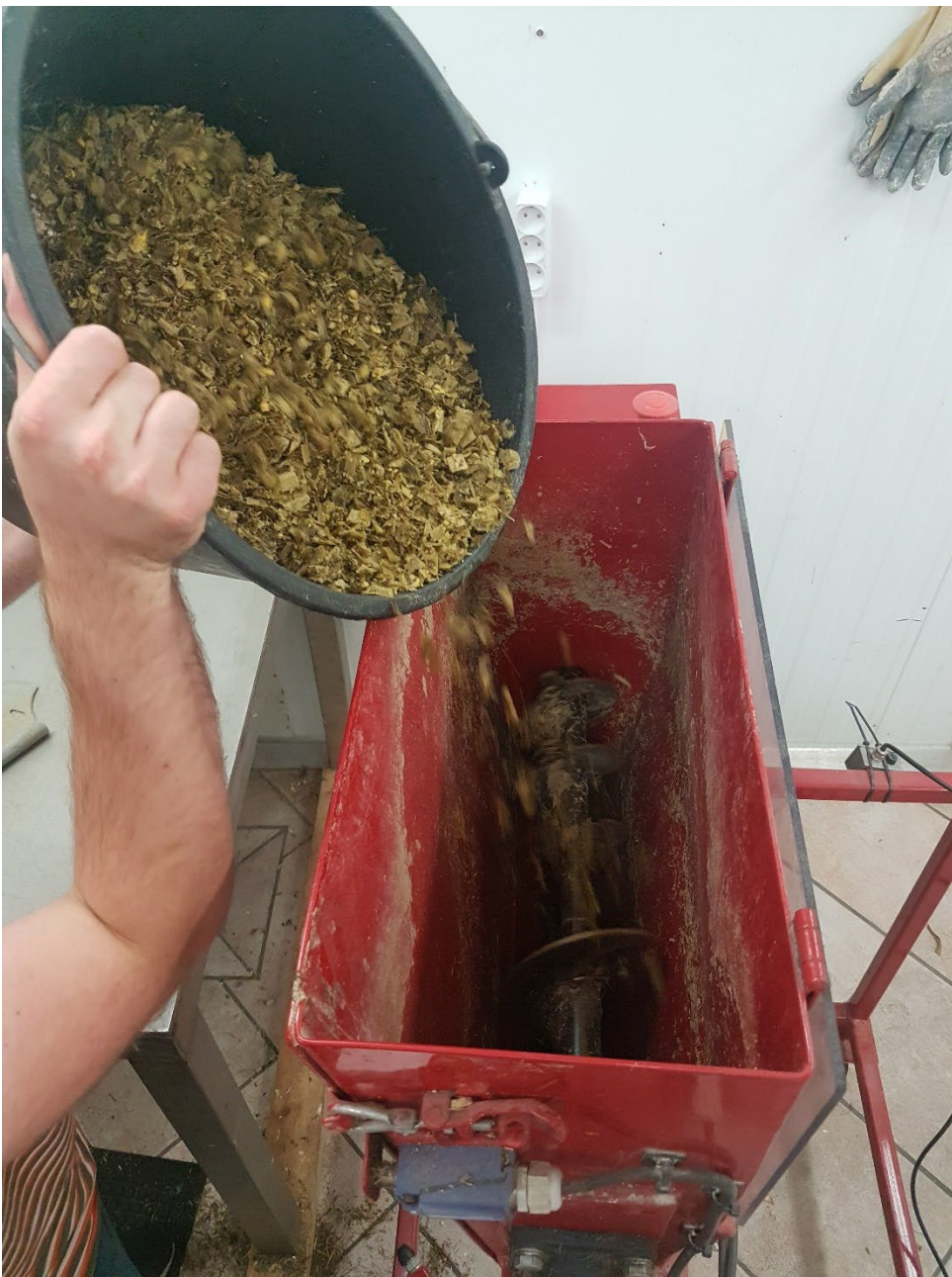
Foto 1. Forsøgsblander til opblanding af små foderbatch (4,0 kg) til fuldfoder. Blandetid var 10 min efter indvejning af alle ingredienser inkl. stabiliserede additiver.
