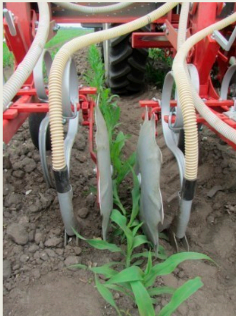
Billede 2. Billedet viser gødningsudstyr, monteret på en radrenser. Gødningen lægges i jorden 10 til 15 cm fra rækken bag den yderste tand på radrenseren. Gødningen kan enten placeres på den ene side af rækken eller på begge sider af rækken som vist på billedet. Foto: Henning Sjørslev Lyngvig, SEGES.
