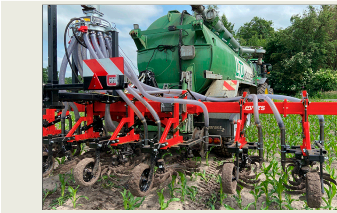
Billede 1. Billedet viser en Evers Inter-row crop injector, som nedmulder gylle mellem majsrækkerne.
