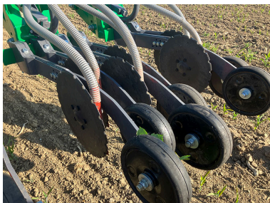
Billede 1. GST Row Seeder som radsår efterafgrøde i 4 såspor mellem to majsrækker. Såmaskinen er ikke kombineret med en radrenser og egner sig godt til såning af efterafgrøde i pløjefri dyrket majs med planterester på jordoverfladen.. Foto: Henning Sjørsløv Lyngvig, SEGES Innovation.
