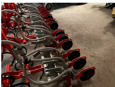
Billede 2. Ingemann Larsen har udviklet udstyr til radsåning med trykhjul og dybdestyring. Udstyret kan monteres på alle typer radrenser. Radafstanden kan justeres, og der kan monteres 3 eller 4 såskær mellem to majsrækker. Foto: Ingemann Larsen A/S.
