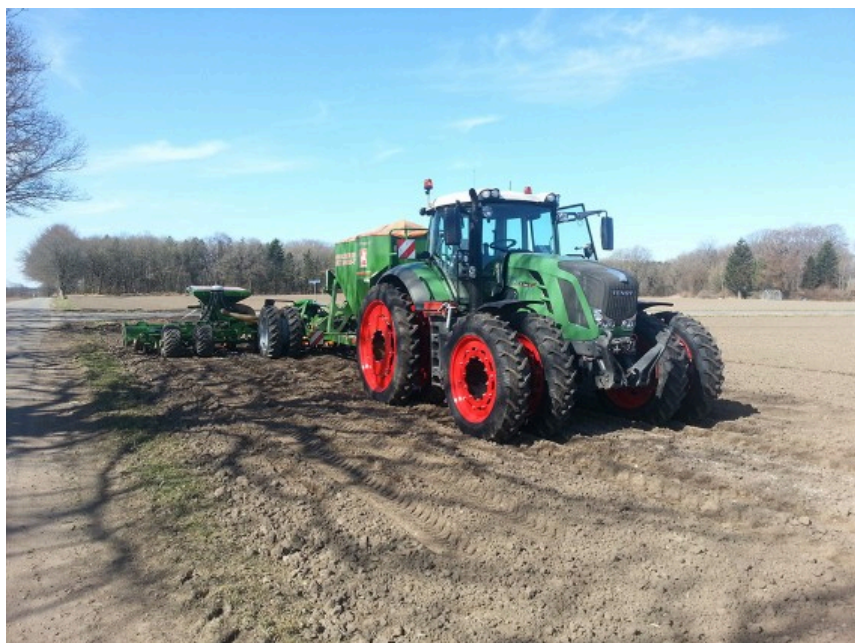
Billede 3. Billedet viser et eksempel på korrekt hjulmontering ved såning af majs på både traktor og såmaskine. Hjulene er monteret, så der ikke ses i hjulsporene. Der er monteret 280 mm brede dæk. En montering med lidt bredere hjul, 380 mm til maks. 480 mm dæk, kan give dækkene et bedre greb og en større bæreflade. Med en
