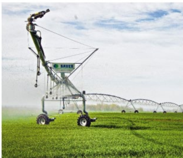
Billede 9. GPS-styret endesektion "knækket". Hjulene drejer sektionen på plads. Foto: Röhren- und Pumpenwerk Bauer.
