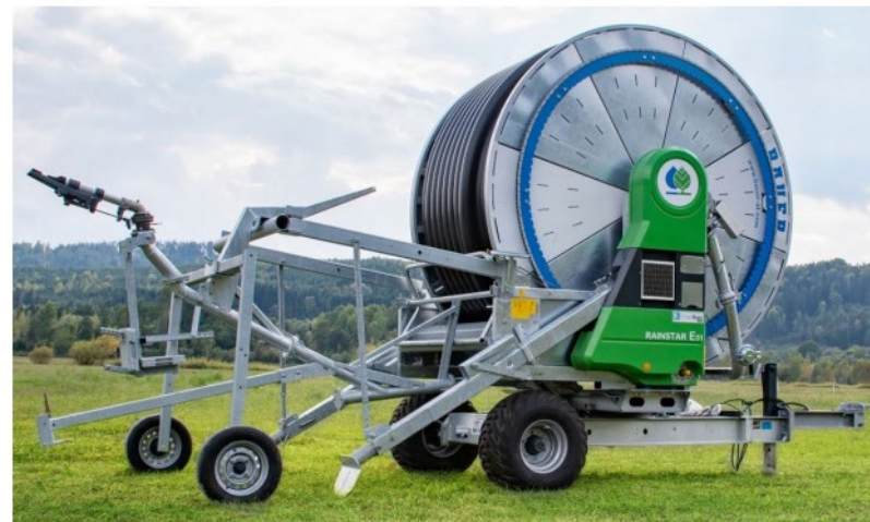
Billede 3. Indtræksmaskine og indtræksvognen med kanonen i transportstilling. Foto: Röhren- und Pumpenwerk Bauer.
