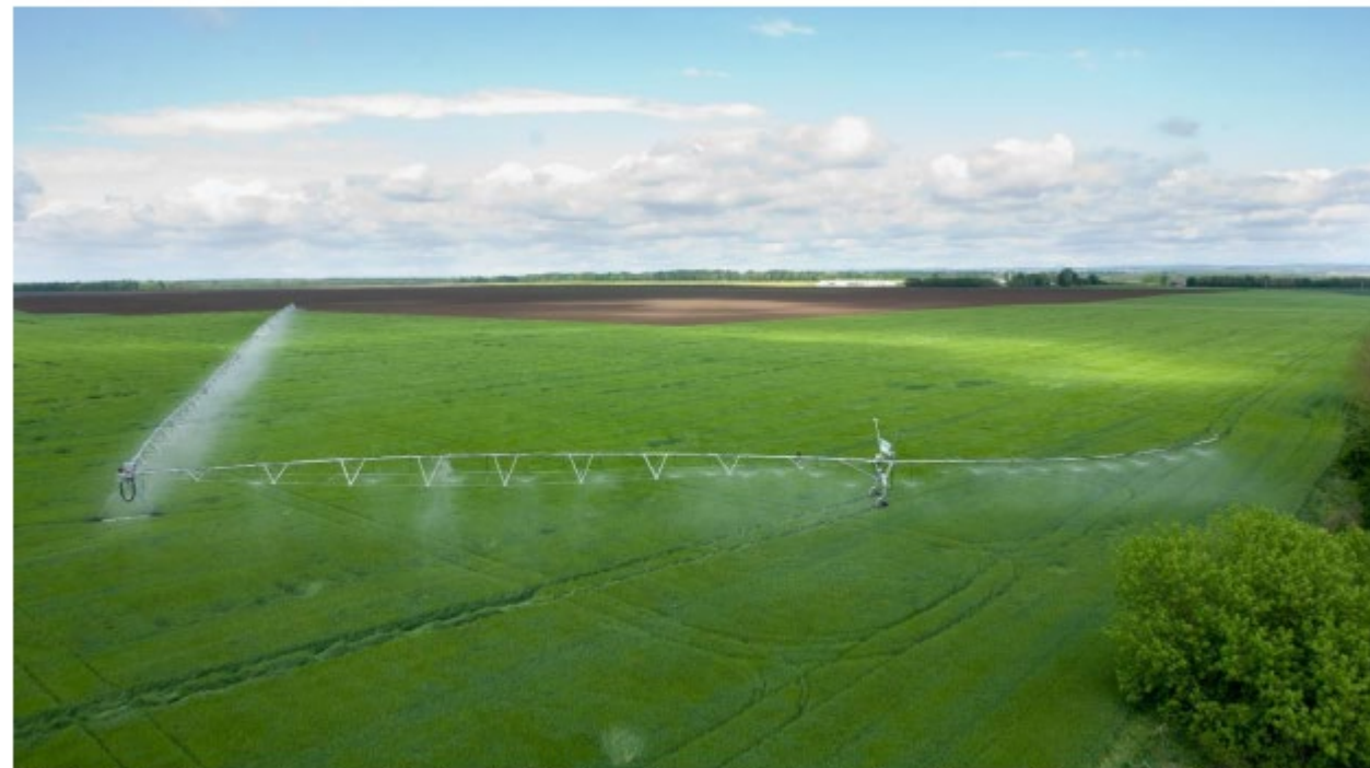
Billede 16. To af tre center-pivotanlæg hos Poul Hilhorst har en GPS-styret endesektion med kurvestyring. Det muliggør at markhjørnerne vandes bedre, så ca. 80-90% af marken kan vandes. Foto: Röhren- und Pumpenwerk Bauer.
