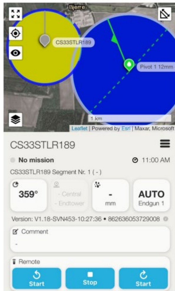
Billede 10. Screen shot fra vært 1, hvor det vises om anlægget kører, kørselsretningen og hvor mange mm der tildeles.
