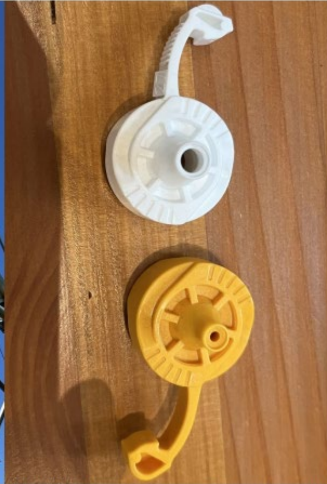
Billede 7. Vandmængden pr. dyse reguleres med forskellige dyse-indsatser. Størrelse beregnes ift. periferihastighed. Foto: Henning Sjørsløv Lyngvig, SEGES Innovation.
