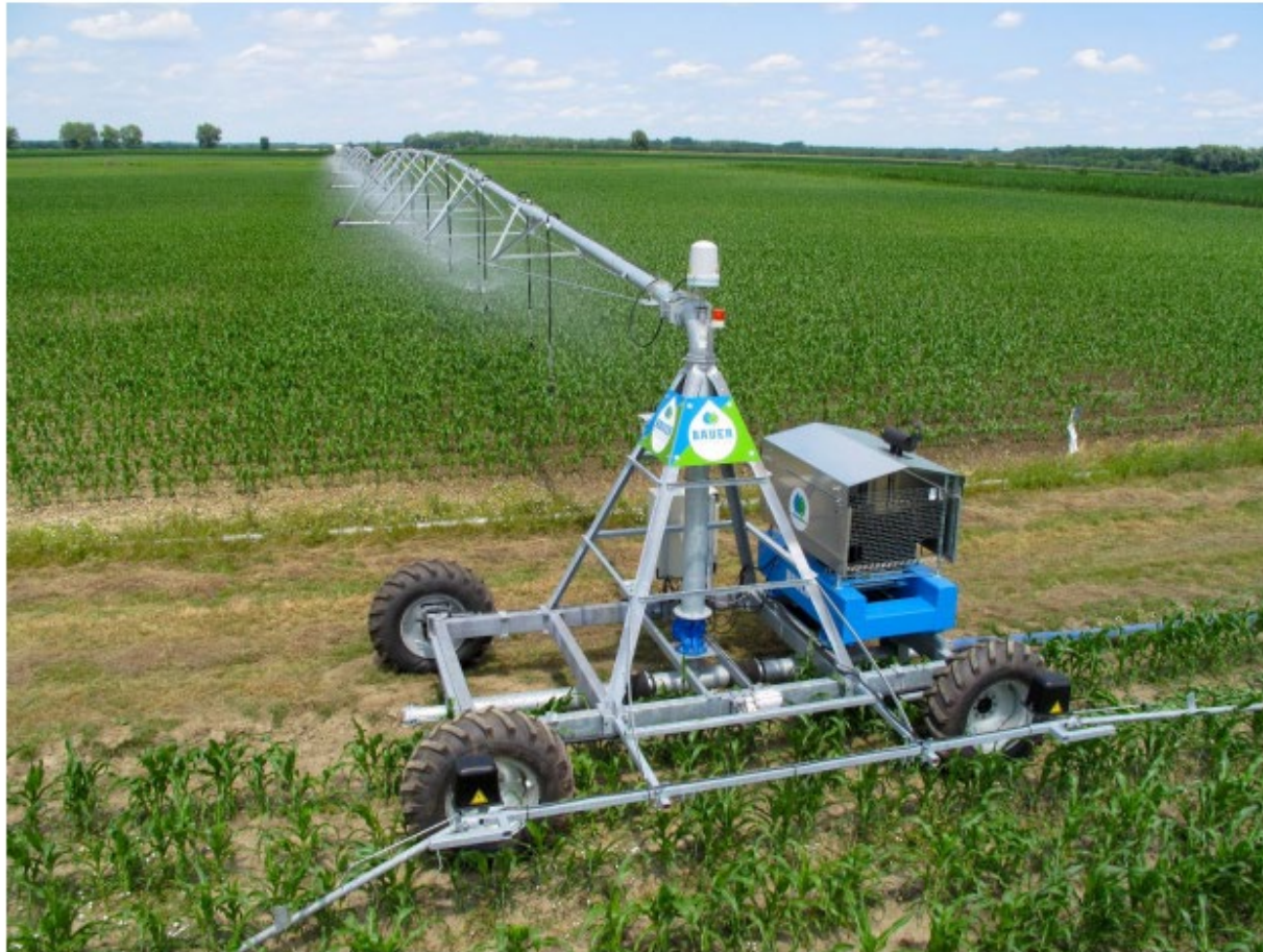
Billede 14. Centerpunktet på den firehjulede vogn på PL-anlæg. Bommen kan dreje 180 grader, når det når enden. Foto: Röhren- und Pumpenwerk Bauer.
