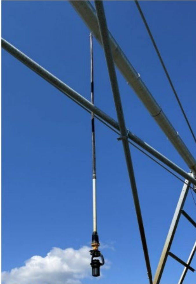
Billede 6. 360 graders rotordyserne har en vis vægt og er monteret på et stålør for at minimere vindfølsomheden. Foto: Henning Sjørsløv Lyngvig, SEGES Innovation.
