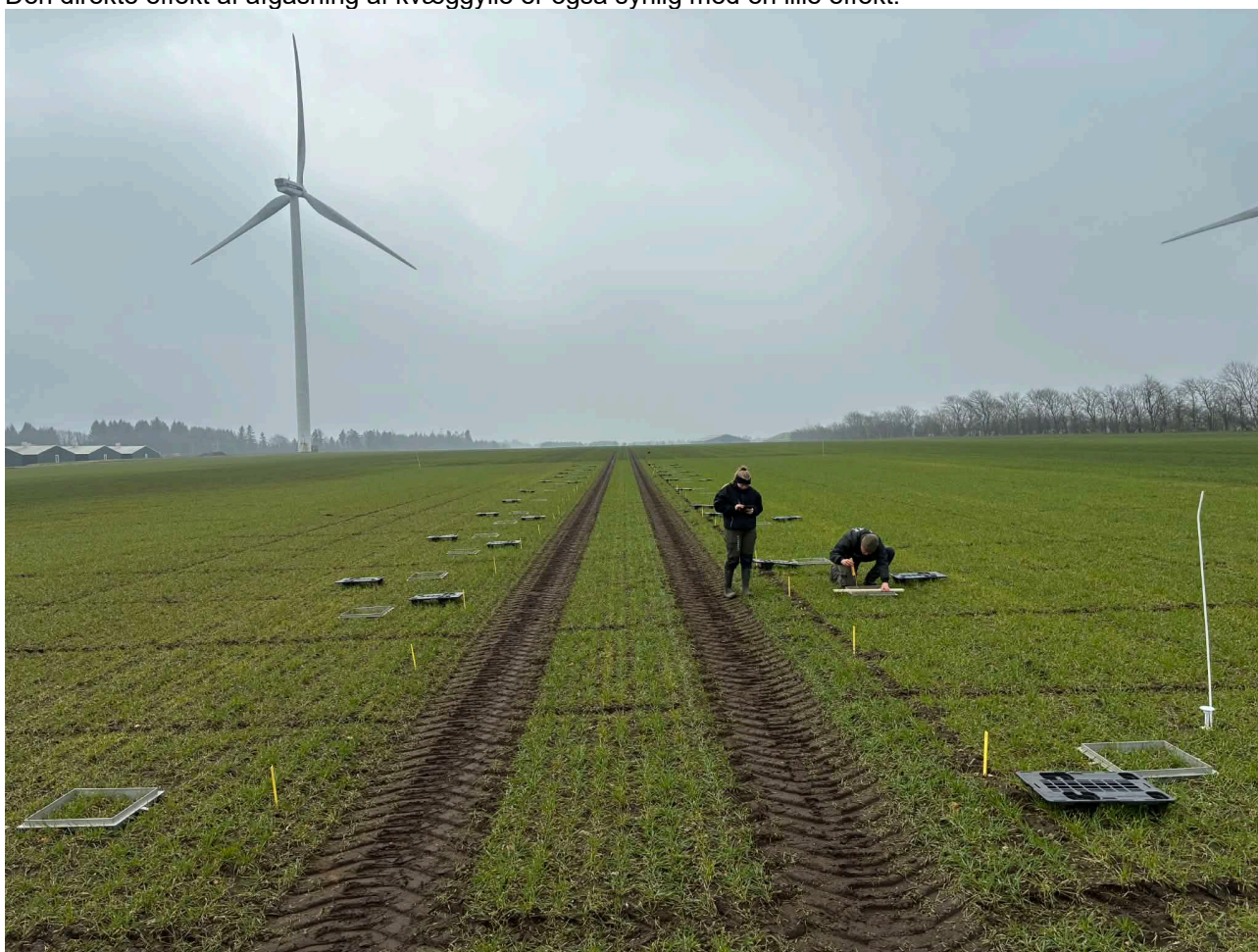
Billede fra 070942626-002 marts 2026. Opmåling af rammehøjde til korrekt beregning af latterflukse umiddelbart inden første målerunde.
