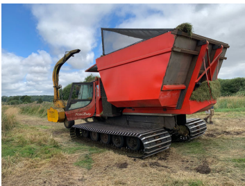
Nyudviklet høstmaskine til sumpe i projekt Høsttek. Foto Frank Bondgaard, SEGES Innovation.
