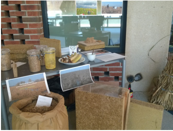
Isoleringsmateriale lavet af dunhammer i Tyskland. Foto Frank Bondgaard
