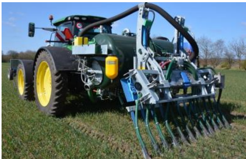
Figur 2: Ytteborgs forsøgsgyllevogn, der blev brugt til at udbringe de forskellige gødningsprodukter
