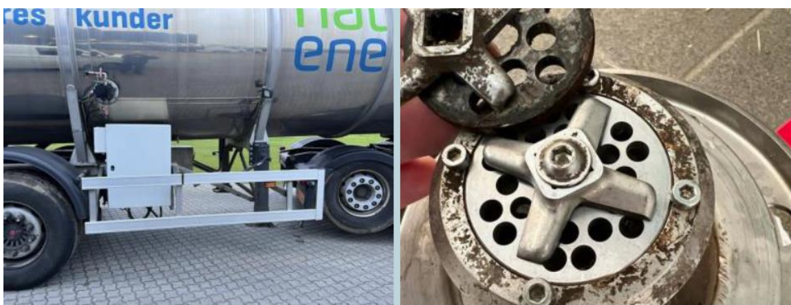
Figur 2: Den mobile Tveskaeg-enhed er installeret på én af Nature Energy's gyllebiler. Th ses neddeleren, der sikrer at prøven kan passere ind i Tveskaeg-enheden
