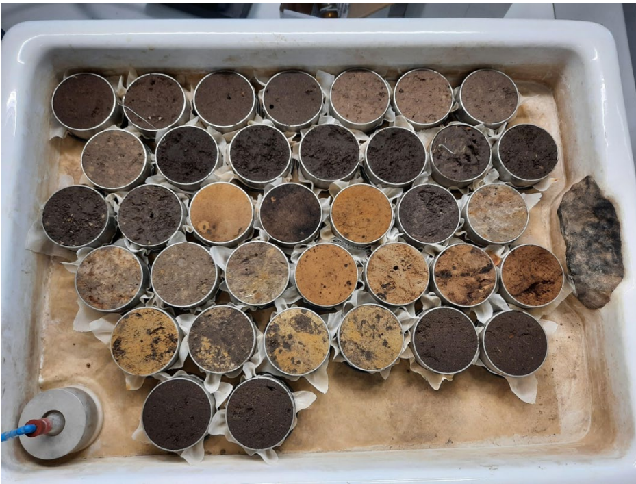
Figur 32. Ringprøver i sandboks udtaget forsøgene 2020 i 8-12 og 38-42 cm dybde. Ringprøverne er ikke sorteret efter dybde eller lokalitet. Foto: Ingeborg Frøsig Pedersen.
