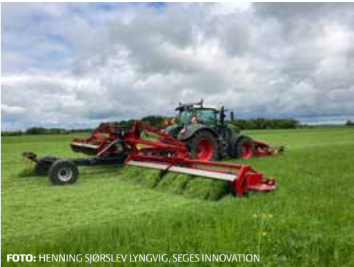
De ekstra sporsæt ved skårlægning er lavet ved at forskyde skårlægningen 6 m og hæve dele af butterflysættet.
