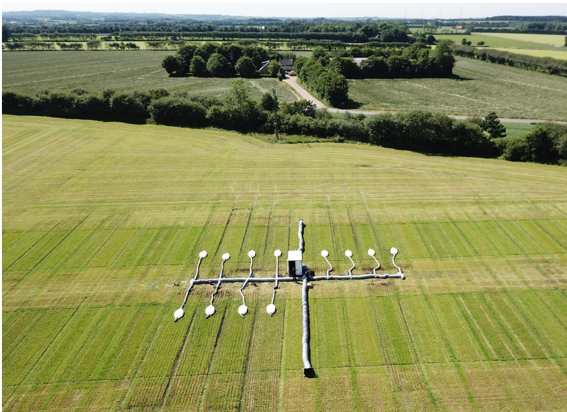
Figur 1 Fotoet viser ammoniak-målesystemet i forsøget. Friskluftsystemet ses med luftindtræk fra to sider på tværs af forsøget. Friskluftsystemet sender luft gennem rørene og det vil sige at det er den samme luft som sendes hen over arealet inde i alle vindtunnellerne. Målevognen er placeret i midten og her samles alle måleslanger fra vindtunnellerne, hvor der måles ammoniakkoncentration via Picarro (foto: Torkild Birkmose, SEGES Innovation).
