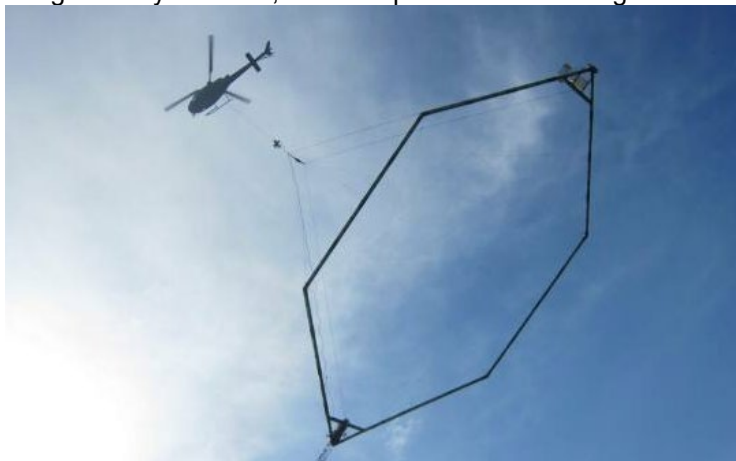
Figur 7. Billede af SkyTEM opstillingen, hvor helikopteren flyver rundt med den påmonteret ramme hvor strømmen sendes igennem og hvor modtagerspolen også sidder. Foto fra SkyTEM.
