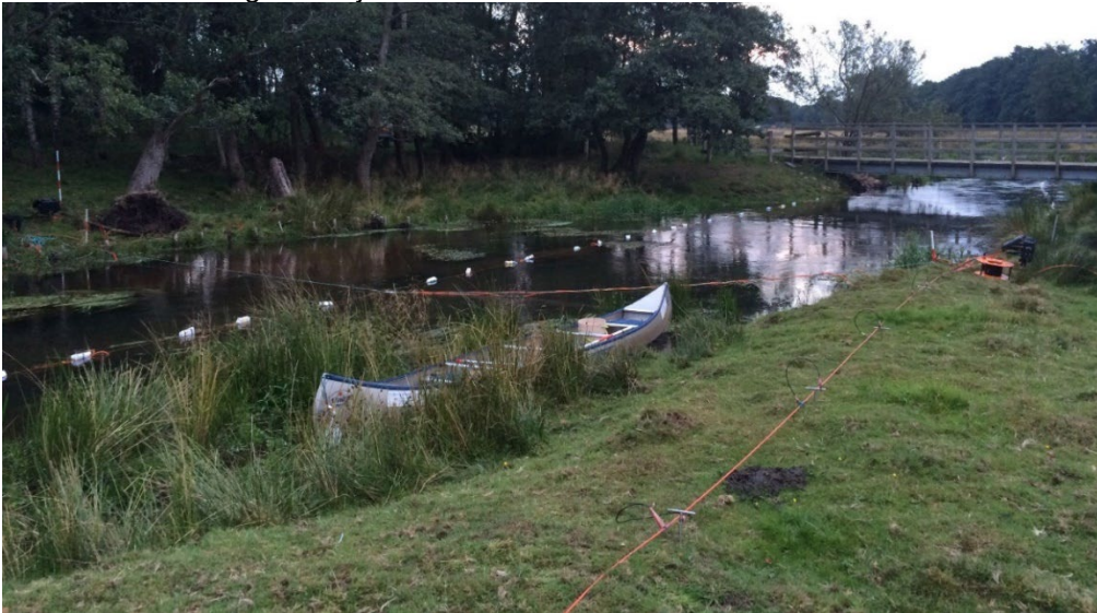
Figur 4. MEP-metoden vist, hvor jordspyddene er koblet til den orange ledning, hvor strømmen sendes ud. Her er lavet en opstilling, hvor der også måles over åen via flydende elektroder. Foto: Helle Holm.
