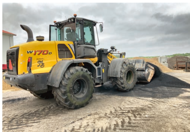
Læsning af biochar med læsemaskine. Foto: Henning Sjørsløv Lyngvig.
