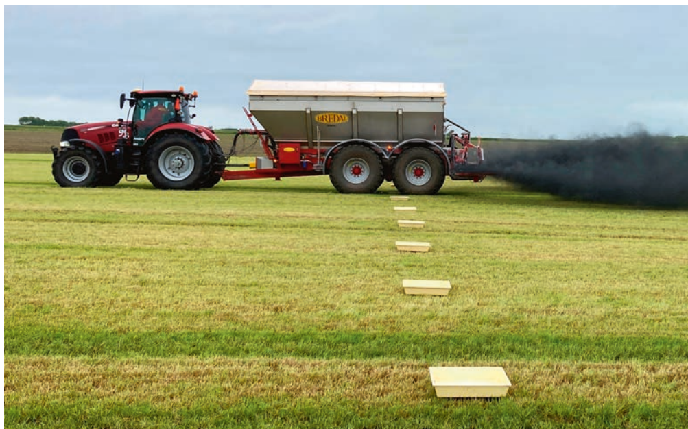
Spredning af biochar i Farmtesten. Øverst med kalkspreader Bredal K-XE til moderate mængder biochar. Nederst møgspreader Samson SPE-21 til store mængder biochar. Foto: Henning Sjørsløv Lyngvig.
