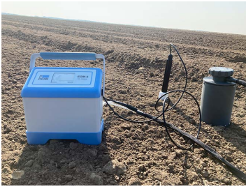
Billede 1. Måling af jordrespiration i biochar-forsøg med EGM-5 tilsluttet CO 2 -kammer jordfugtighedssensor. Billedet er fra marts. Foto: Nanna Schrøder Baggesen.
