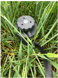
Billede 2. Måling af jordrespiration i biochar-forsøg med EGM-5 tilsluttet CO 2 -kammer jordfugtighedssensor. Billedet er fra juni. Foto: Nanna Schrøder Baggesen.
