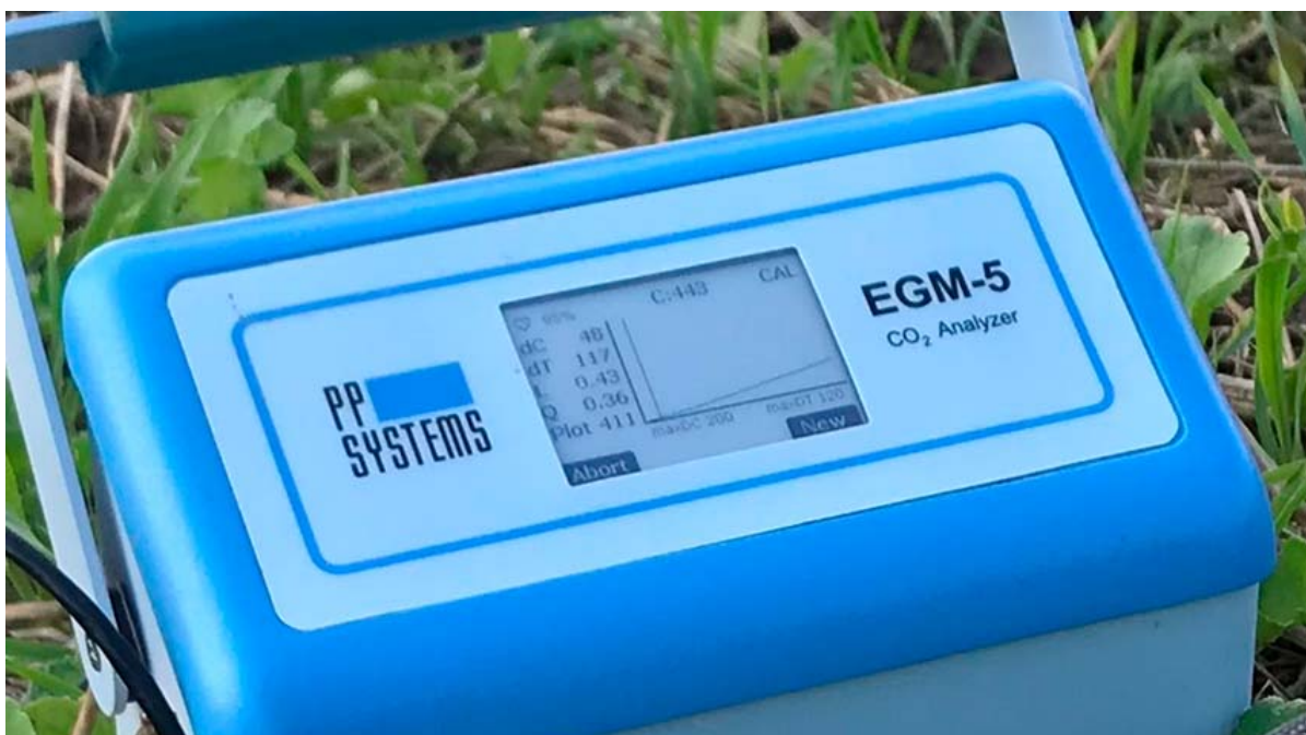
Billede 3. Nærbillede af skærmen på EGM-5 der viser den stigende CO 2 -koncentration i en graf med tiden ud af x-aksen og CO 2 -koncentrationen op af y-aksen. Foto: Nanna Schrøder
