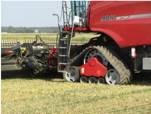
Figur 3: Eksempel på en konsekvens af et vådere vejr og dårlige dræningsforhold: Maskinelle ændringer som brug af gummibælter i stedet for dæk. Foto: Henning Sjørsløv Lyngvig.
