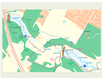
Billede 1. Illustration over, hvilke tiltag der er udført under klimatilpasningsprojektet i Hylkedalen. Det ene jorddige er etableret helt ude ved motorvejsbroen, mens det andet er placeret længere opstrøms i Seest Mølleå. Kilde: Kolding Kommune.
