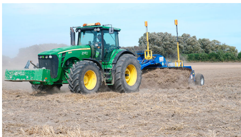
Billede 2: Planeringen udføres med en grader, der skubber jorden med sig rundt og fordeler det jævnt på marken. Foto: Martin Stoltenberg Hansen, SEGES Innovation.
