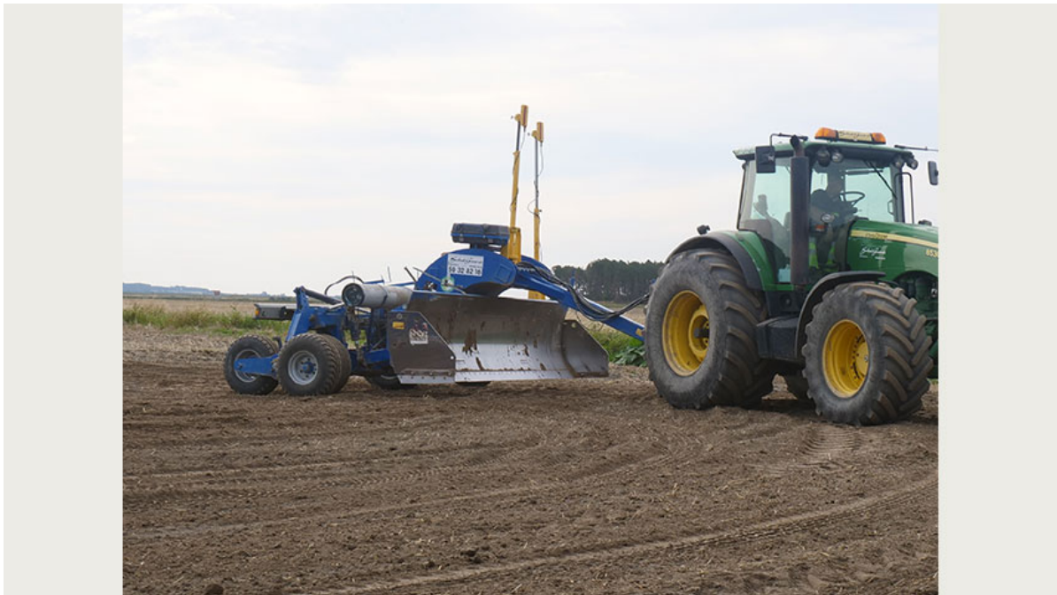
Billede 2. Planeringen udføres med en grader. Foto: Martin Stoltenberg Hansen, SEGES Innovation.
