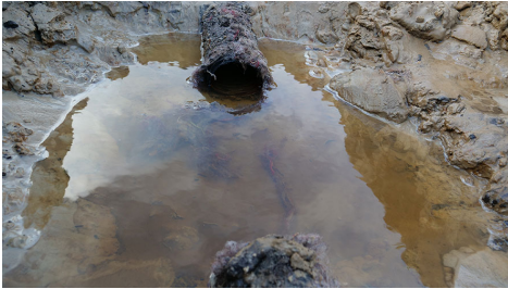
Billede 3: PP450 L-plov. Har var ingen nævneværdig sandindtrængning. Der var svage tegn på okker, men det var ikke noget der var problematisk. Foto: Martin Stoltenberg Hansen, SEGES Innovation.
