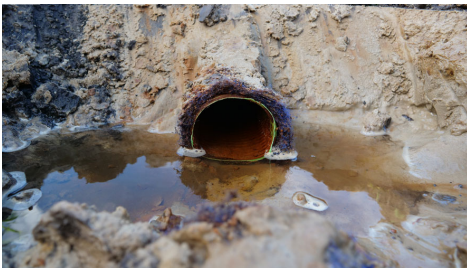
Billede 6: PP1000 V-plov. Her blev fundet lidt mere sand i rørene. Tæpperør med åbenhed på 1000 kunne altså tyde på at være for åbne til denne jord. Foto: Martin Stoltenberg Hansen, SEGES Innovation.
