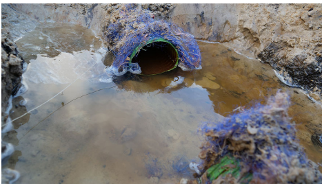
Billede 4: PP700 V-plov. Ingen betydende sandindtrængning. Foto: Martin Stoltenberg Hansen, SEGES Innovation.
