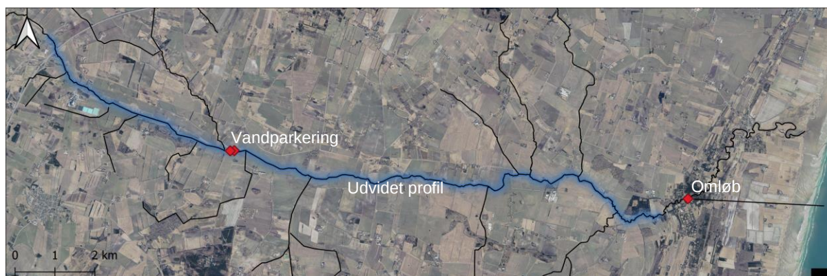
Figur 5.1 Oversigt over modelopsætning i scenarie B med vandparkering, omløb fra Gerå til Kattegat og udvidet vandløbsprofil markeret med blå i Gerå.
