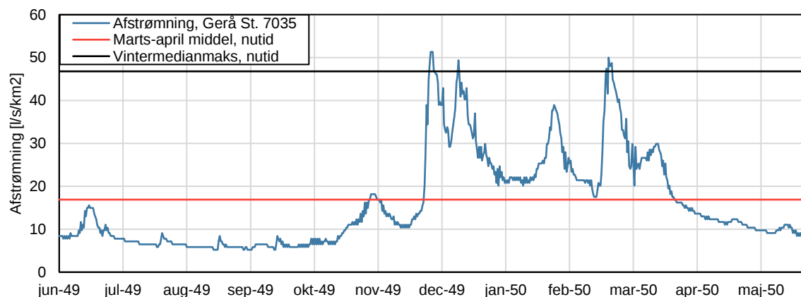
Figur 5.4 Modelleret døgnmiddelfafstrømning referencescenarie for fremtidens klima i den udvalgte analyseperiode.
