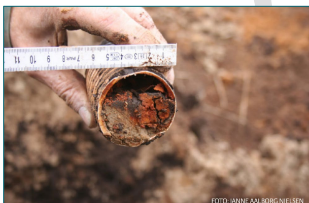
Figur 14. Drænrør kan være defekte, fordi de er blevet tilstoppet af okker (venstre) eller er blevet klemte (højre). (Fotos: Janne Aalborg Nielsen).
