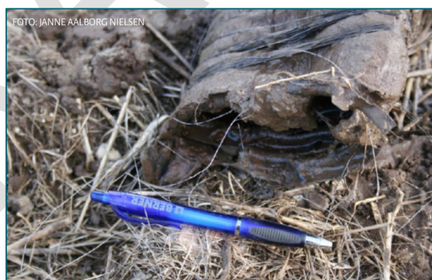
Figur 14. Drænrør kan være defekte, fordi de er blevet tilstoppet af okker (venstre) eller er blevet klemte (højre). (Fotos: Janne Aalborg Nielsen).
