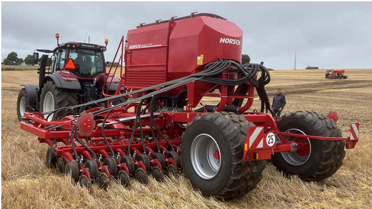
Såmaskine 4. Horsch Avatar repræsenterer skiveskærssåmaskine med ligevinklede skiveskær. Foto: Henning Sjørlev Lyngvig, SEGES Innovation.
