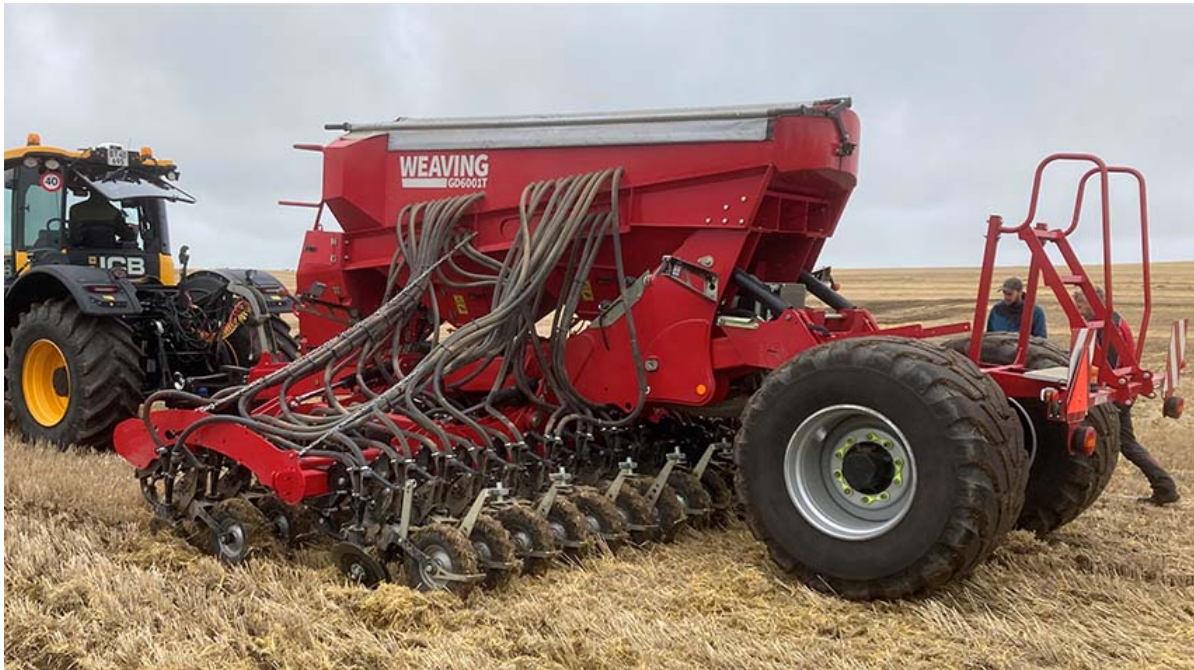
Såmaskine 3. Weaving GD repræsenterer skiveskærssåmaskine med 25° vinklede skiveskær. Foto: Henning Sjørlev Lyngvig, SEGES Innovation.
