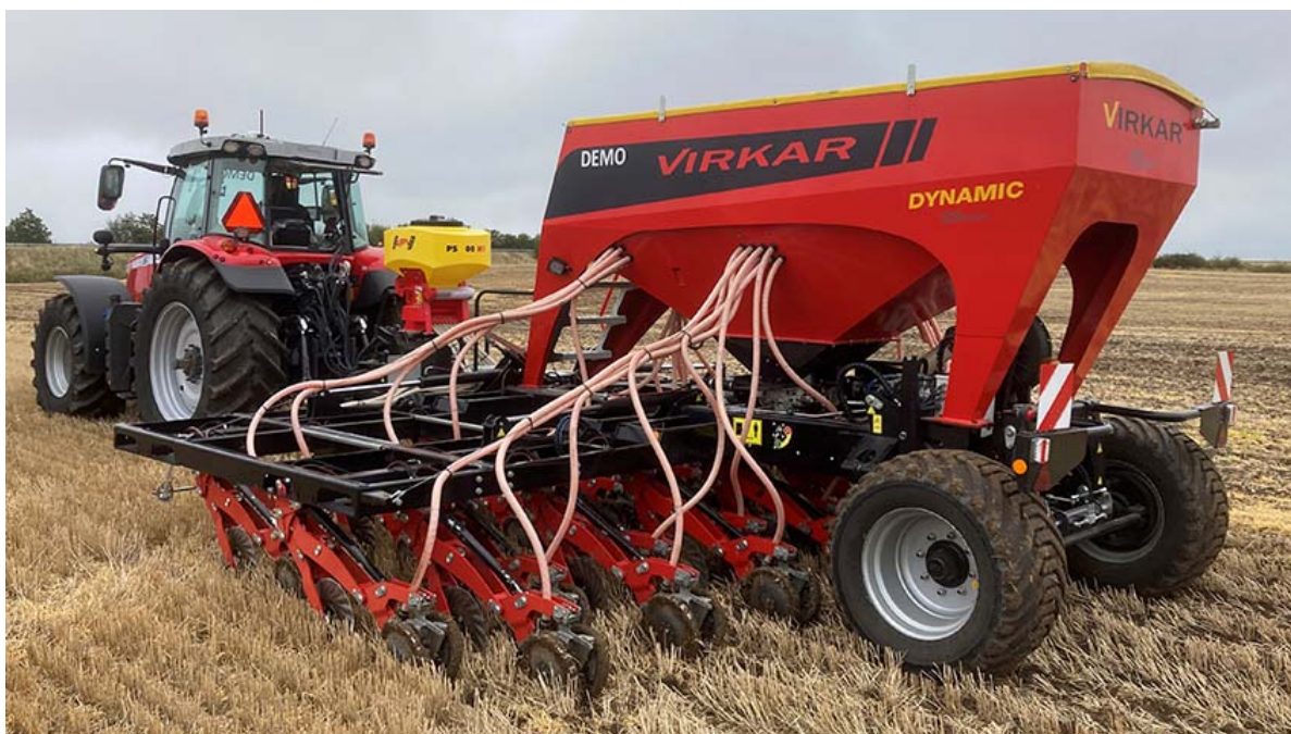
Såmaskine 1. Virkar Dynamic repræsenterer tandskærssåmaskiner med individuel dybdestyring. Foto: Henning Sjørslev Lyngvig, SEGES Innovation.
