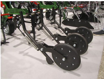
Billede 1. Thyregod A/S har udviklet en teknik til såning med brug af trykhjul, der kan monteres på deres radrenser. Frøene radsås i tre såspor med slæbeskær og tryk- og dybdestyringshjul. Foto: Henning Sjørsløv Lyngvig, SEGES Innovation.
