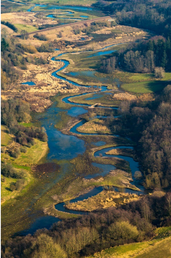
Genslyngning og hævnning af vandløbsbund
