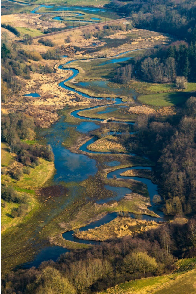
Genslyngning og hævnning af vandløbsbund
