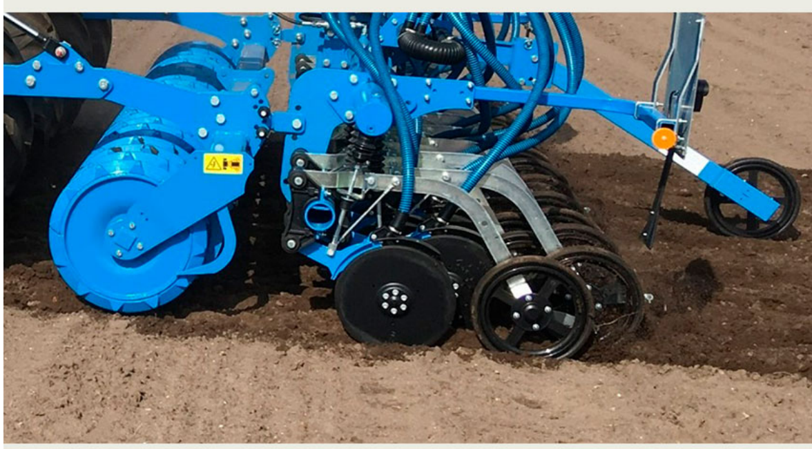
Billede 1. Säteknik med pakvalse, dobbelte skiveskær og trykrulle i såsporet er velegnet til etablering af kløvergræs. Desværre er der mange, der også sår for dybt med den nye teknik, så indstil såmaskinen korrekt. Man må gerne kunne se cirka 10-15 pct. af frøene i såsporet efter såning. Foto: Torben S. Frandsen, SEGES Innovation.
