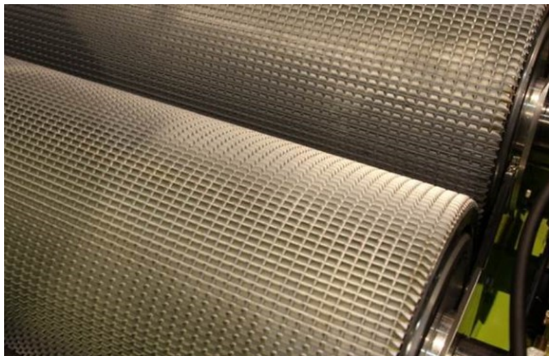
Billede 1. Billedet viser de to valser i en Shredlage cracker. Valserne har en riflet og ru overflade og løber med ca. 50 pct. forskel i hastighed. Det betyder, at de er mere effektive til at rive blade, stængler og kerner i stykker end en traditionel cracker. Fibertech valser har en lignende udformning og kan lave samme produkt som en Shredlage cracker.
