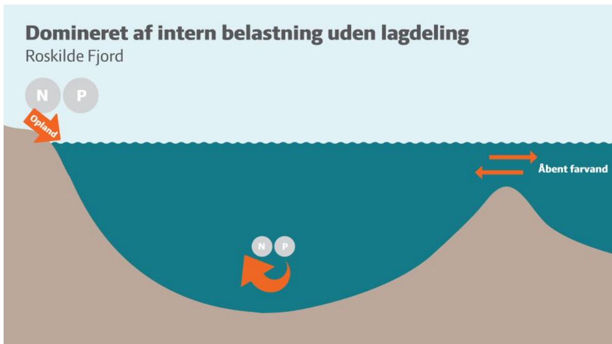
Figur 5.1 Forsimplet illustration af et fjordsystem, som er domineret af intern belastning uden lagdeling. Den fjord som i analysen kan klassificeres således er Roskilde Fjord.
