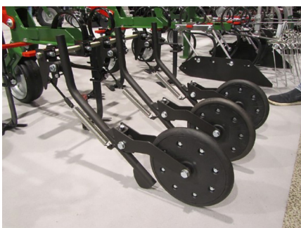
Billede 1. Thyregod A/S har udviklet en teknik til såning med brug af trykhjul, der kan monteres på deres radrenser. Frøene radsås i tre såspor med slæbeskær og tryk- og dybdestyringshjul. Foto: Henning Sjørsløv Lyngvig, SEGES Innovation.
