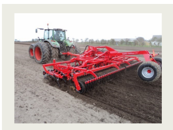
Billede 1. En tung tand- eller discharve, som bæres af pakkevalsen i stedet for hjul, er særdeles velegnet til såbedstilberedning til majs på pløjet jord. Såbedet bliver jævnt og ensartet pakket. Vælg en jernringspakkevalse i stedet for en rørpakkevalse. Foto: HE-VA Aps.
