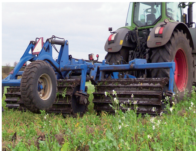
En knivtromle påvirker efterafgrøder mekanisk, og har en høj kapacitet. Den kræver dog høj hastighed for at påvirke olieræddiken.
