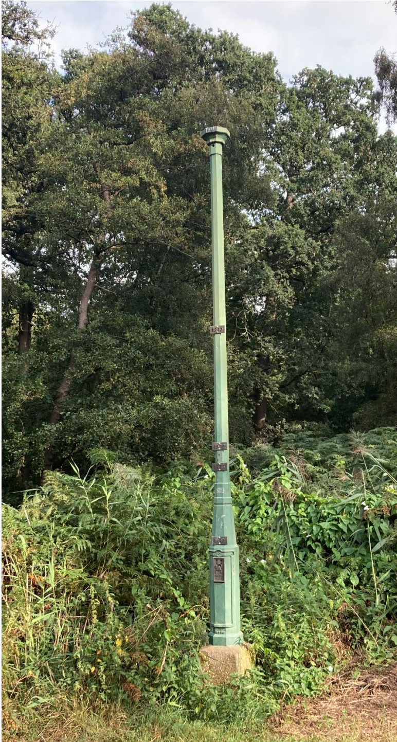
Figur 9: Pæl som blev sat ned i jorden i 1848, inden man begyndte at dræne området. Da pælen blev sat ned, var toppen af pælen i samme plan som jorden. Billede: Majken Deichmann, SEGES Innovation.
