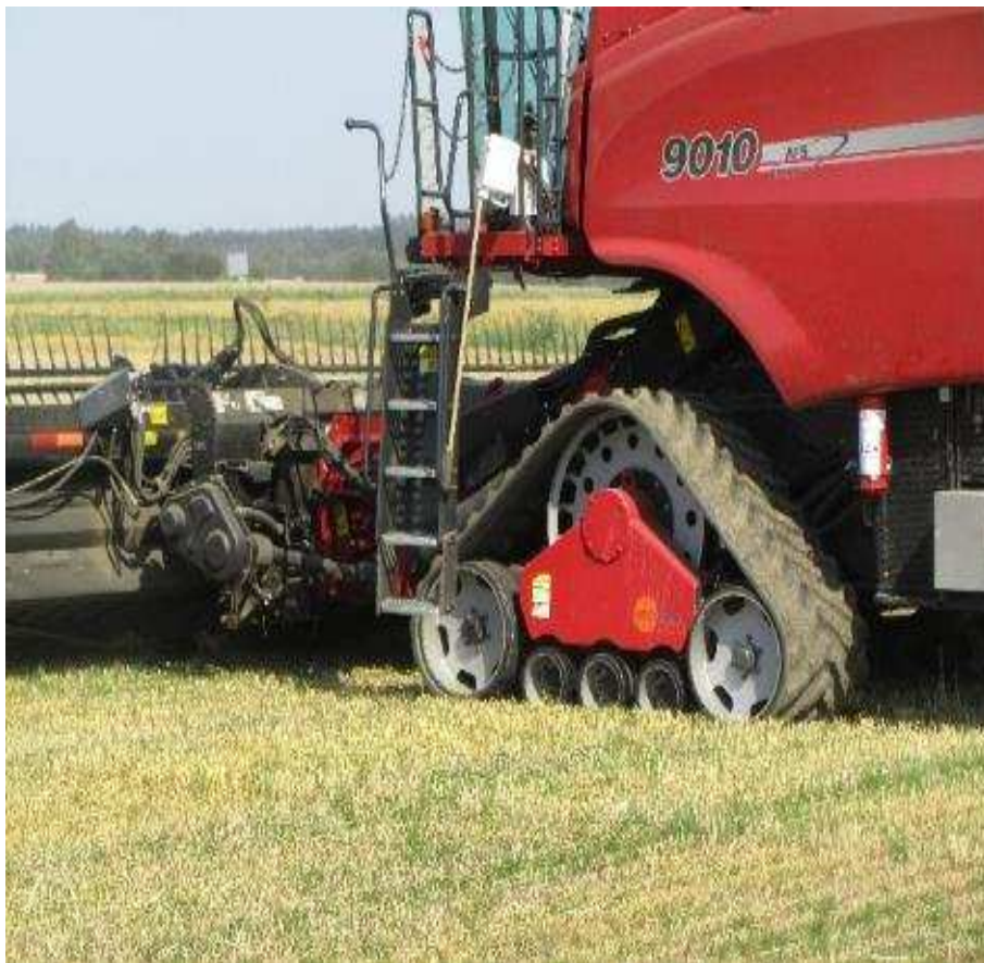
Figur 17: Eksempel på en konsekvens af et vådere vejr og dårlige dræningsforhold: Maskinelle ændringer som brug af gummibælter i stedet for dæk. Foto: Henning Sjørsløv Lyngvig.
