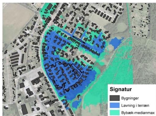
Figur 1: Arealerne der bliver berørt af oversvømmelserne. Grøn farve angiver arealer, der ligger lavere end Bybækkens vandspejl ved medianmaksimum, og blå farve er arealer, der ligger indenfor oversvømmelsesområdet (sort linje viser den dybeste lavning, hvor problemerne opleves først ved oversvømmelse). Figur fra COWI, 2017.
