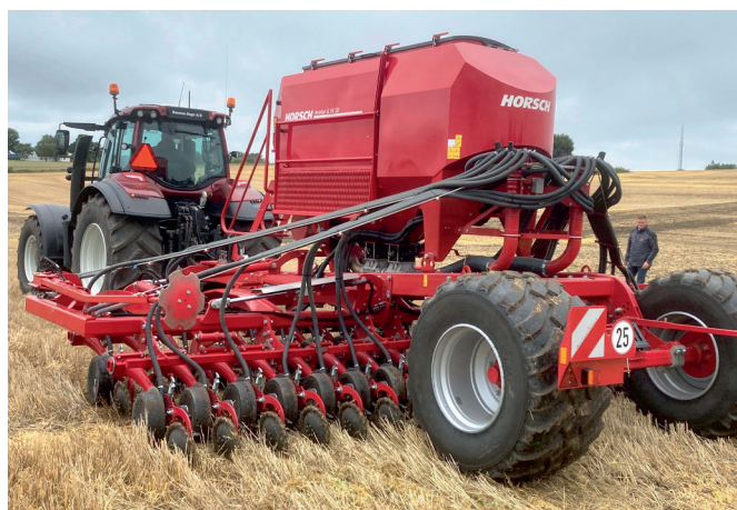
Horsch Avatar repræsenterer skiveskærssåmaskine med ligevinklede skiveskær. Foto: Henning Sjørsløv Lyngvig.
