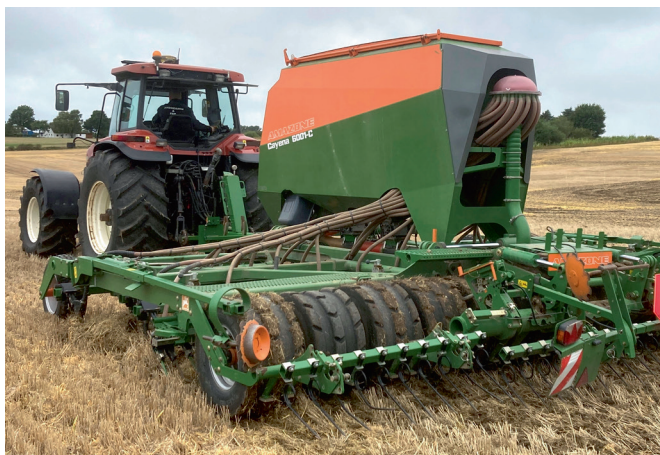
Amazone Cayena repræsenterer tandskærssåmaskiner uden individuel dybdestyring. Foto: Henning Sjørsløv Lyngvig.
