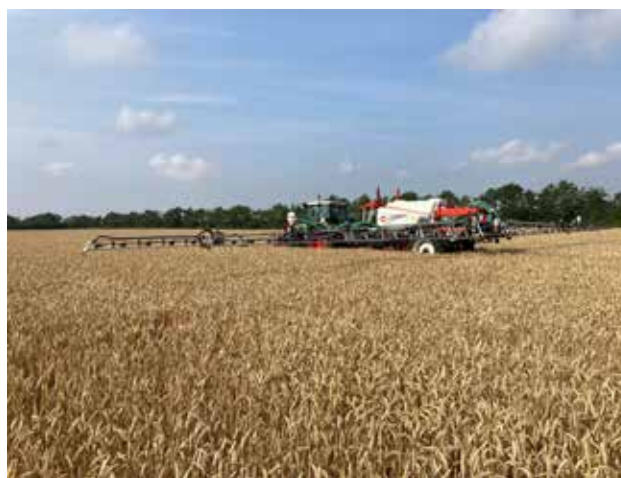
Techneat Outcast V2 spredesystemet har en central frøtank der føder små elspredere monteret på en sprøjtebom på en sprøjtebom.
